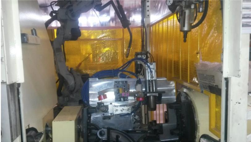
*Figura 6.1 En la imagen se muestra el jig ensamblado con sus respectivos unidades mecánicas y actuadores también se instalo el robot nx100.*
