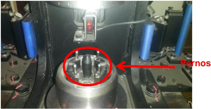
*Figura 5.7 En la figura se muestra los pernos modificados*
