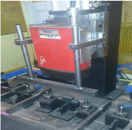
*Figura 6.3 En la imagen se muestra la marcadora 2D con algunos de sus pernos localizadores y bases de asentamiento.*
